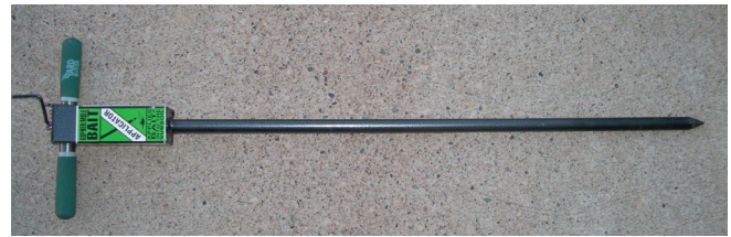
Figura 4. Equipo de mano para la cebadura de tuza. Fotografía de Danielle Gunn
